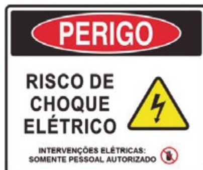
Figura 2 – Exemplo de sinalização para quadro ou painel de comando e potência
