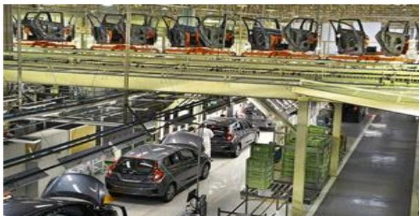
Montagem do HR-V já ocupa um terço da produção em Sumaré e trouxe investimentos como nova linha de solda, transportador aéreo de portas e mais robôs para pintar para-choques. Se comparada à evolução de um ser humano ao longo dos anos, a fábrica da Honda em Sumaré chega perto de completar 18 anos de idade no topo da produtividade, em sua estatura máxima.
